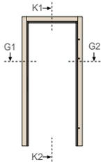
Blindstock mit Anputzwinkel und Anputzleiste für Vollwärmeschutz
